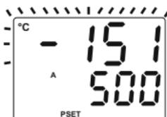
2- Der Wert auf der oberen Anzeige blinks: Wenn der analoge Eingangswert geringer als der minimale Wert im Operationsbereich ist, beginnt der Wert der oberen Anzeige zu blinken **Lol**.
