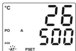
5- Wenn die Abstimmoperation in 8 Stunden nicht beendet werden kann, beginnt das AT- LED zu blinken. Dieses Blinken kann durch das Drücken der Entertaste abgebrochen werden.
