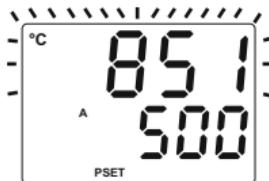
3- Der Wert auf der oberen Anzeige blinkt: Wenn der analoge Eingangswert  $uPL$  als der minimale Wert im Operationsbereich ist, beginnt der Wert der oberen Anzeige zu blinken .
