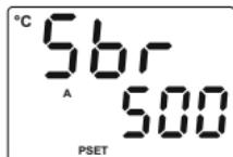
1 - Sensorfehler bei analogen Quellen am Eingang.
