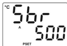
1 - Erreur du capteur dans les entrées analogiques. La connexion du capteur est erronée ou la connexion au capteur n'est pas établie.
